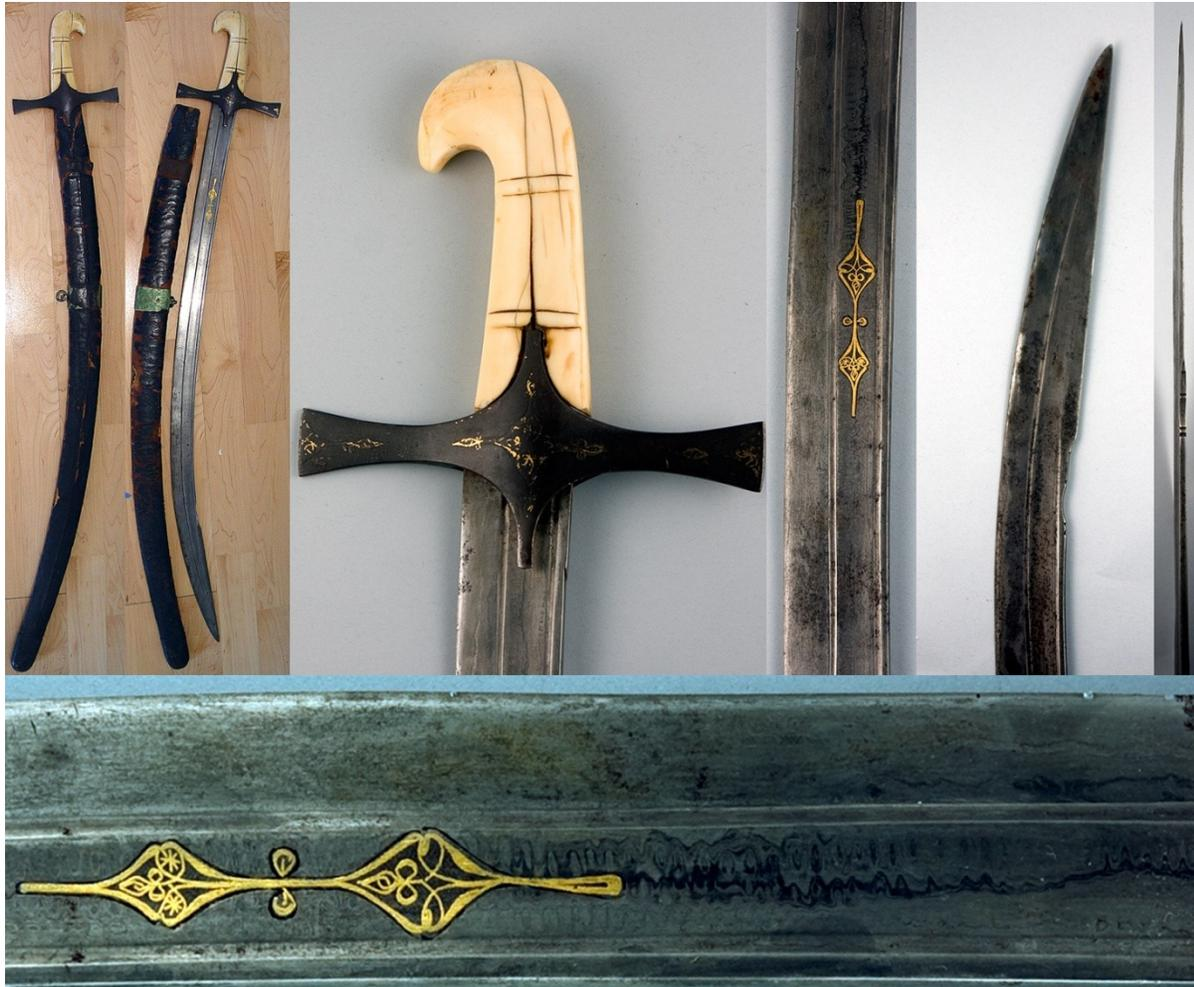
Рисунок 2. Грузинская сабля с «клювовидной» рукоятью, примерно 1800 года. Сложный зигзагообразный узор посередине сочетается с ламинарным узором у края, в непосредственной близости к которому располагается однородная, высокоуглеродистая, закаленная сталь.
